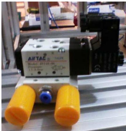
Figura VI-13: Bloque de electroválvulas del proyecto
