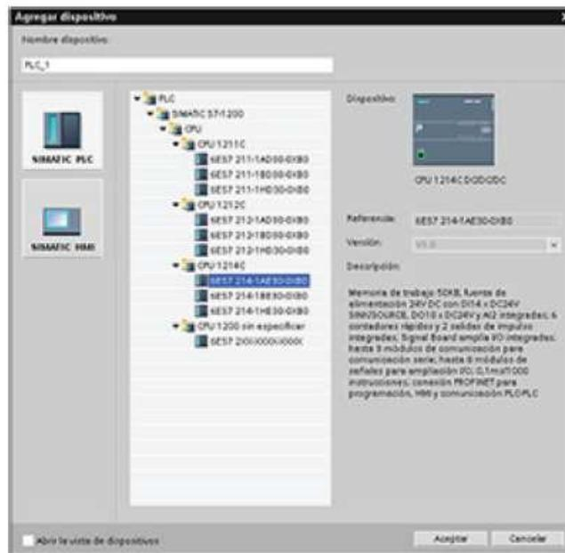
Figura IV-12: Forma de insertar un dispositivo
