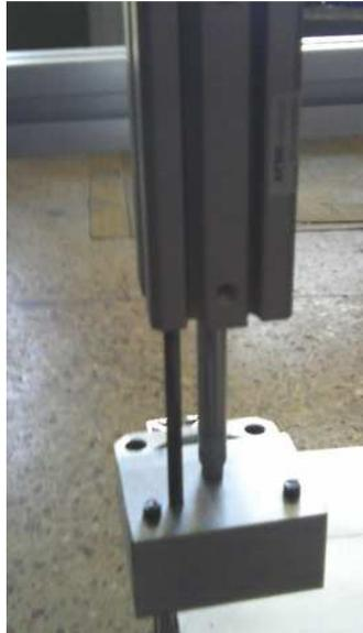
**Figura VI-12: Cilindro de simple efecto y doble efecto**
