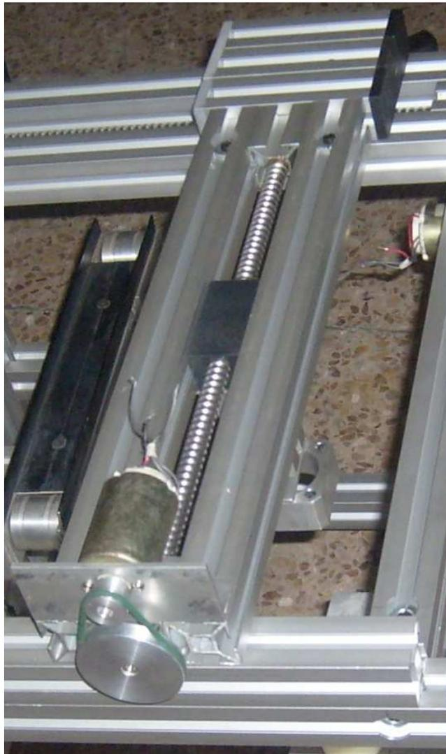
**Figura VI-4: Transmisión de la energía del motor C.C. al usillo por poleas**
