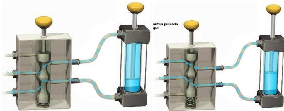
Figura II-30: Funcionamiento de una válvula 5/2
