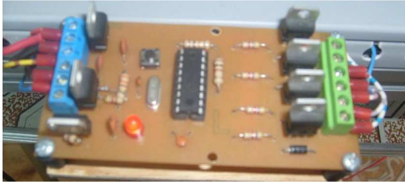
**Figura VI-11: Placa controladora del motor PAP**
