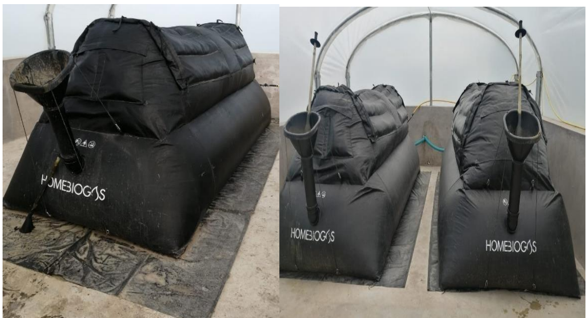
Ilustración 2-1: Biodigestores tecnológicos compactos.
