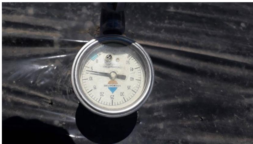
Ilustración 3-3: Tensiómetros instalados en la parcela
