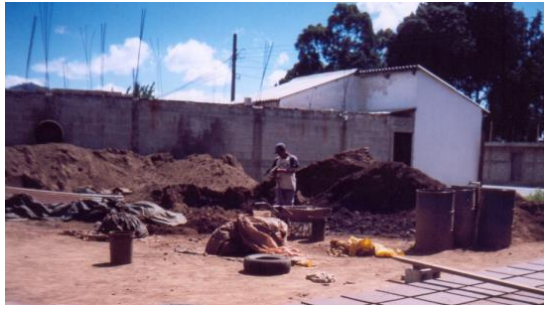
Ilustración 13-2: Maduración o reposo de la arcilla
