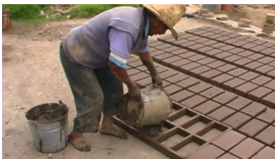
Ilustración 15-2: Moldeado de los ladrillos
