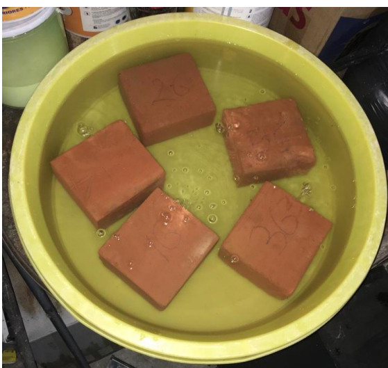
Ilustración 21-3: Probetas sumergidas en agua
