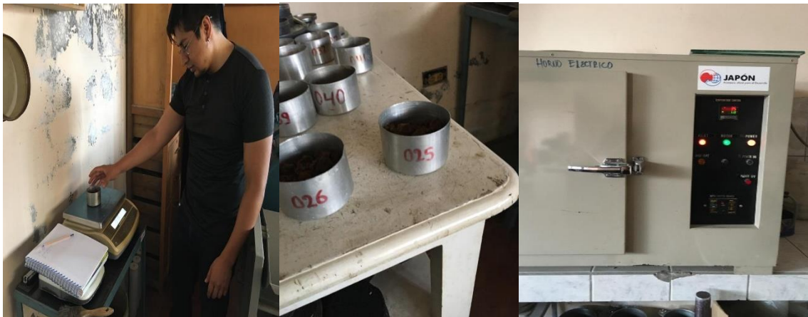
Ilustración 7-3: Cálculo de la humedad de la arcilla
