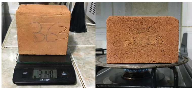
Ilustración 20-3: Secado y pesado en seco de las probetas
