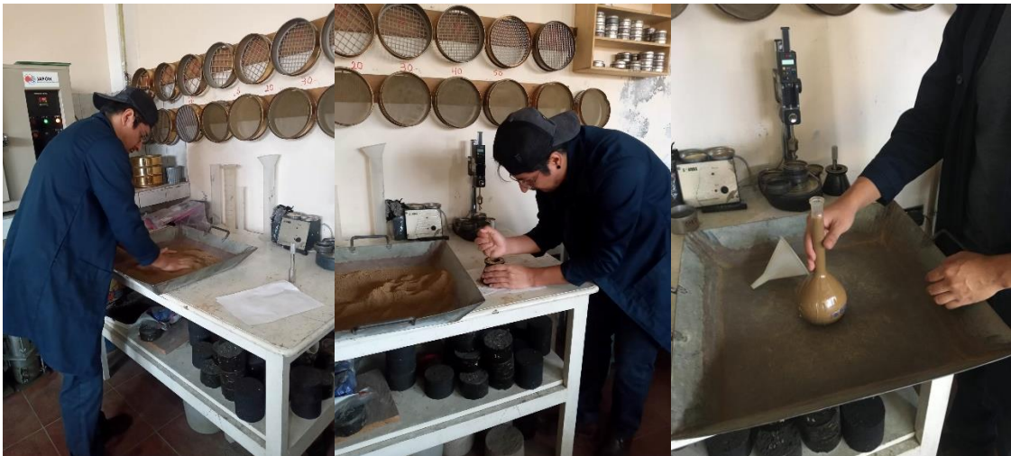
Ilustración 10-3: Cálculo de la capacidad de absorción de la arcilla
