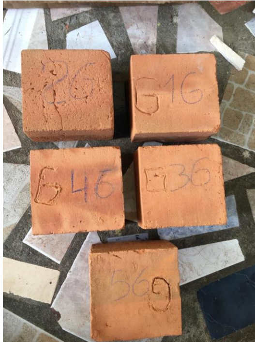
Ilustración 19-3: Probetas para ensayo de absorción
