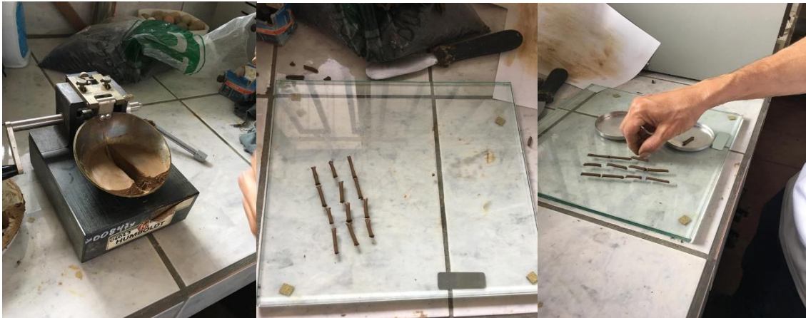
Ilustración 9-3: Cálculo del límite plástico de la arcilla
