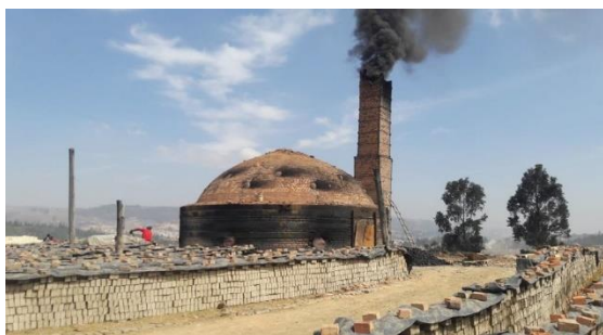
Ilustración 16-2: Cocción de los ladrillos de arcilla
