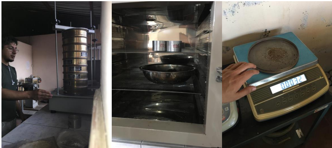
Ilustración 11-3: Cálculo de la granulometría de la arcilla
