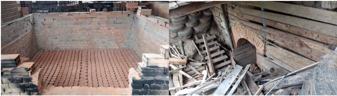
Ilustración 16-3: Proceso de cocción de los ladrillos tipo
