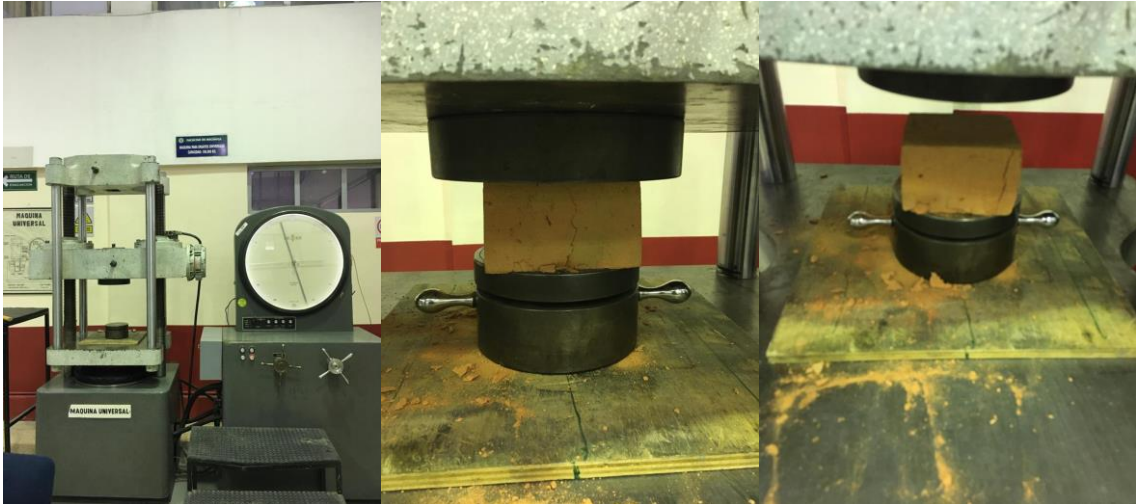
Ilustración 24-3: Ejecución del ensayo de resistencia a la compresión
