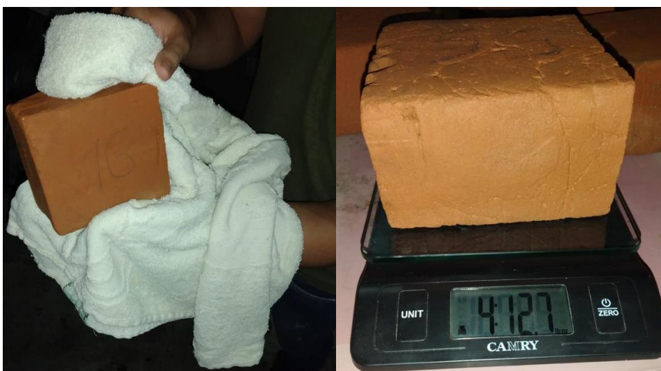
Ilustración 22-3: Secado y pesado después de la sumersión
