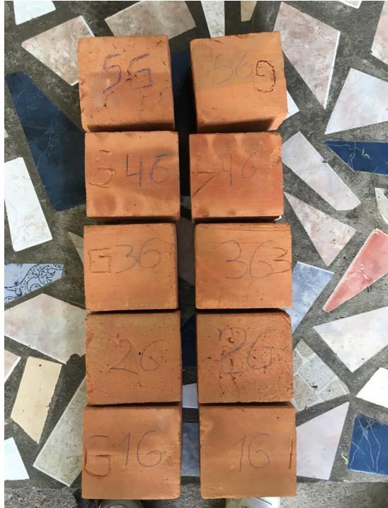
Ilustración 23 -3: Probetas para ensayo de compresión
