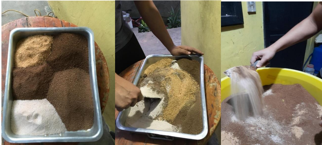
Ilustración 12-3: Dosificación y mezclado para la pasta cerámica
