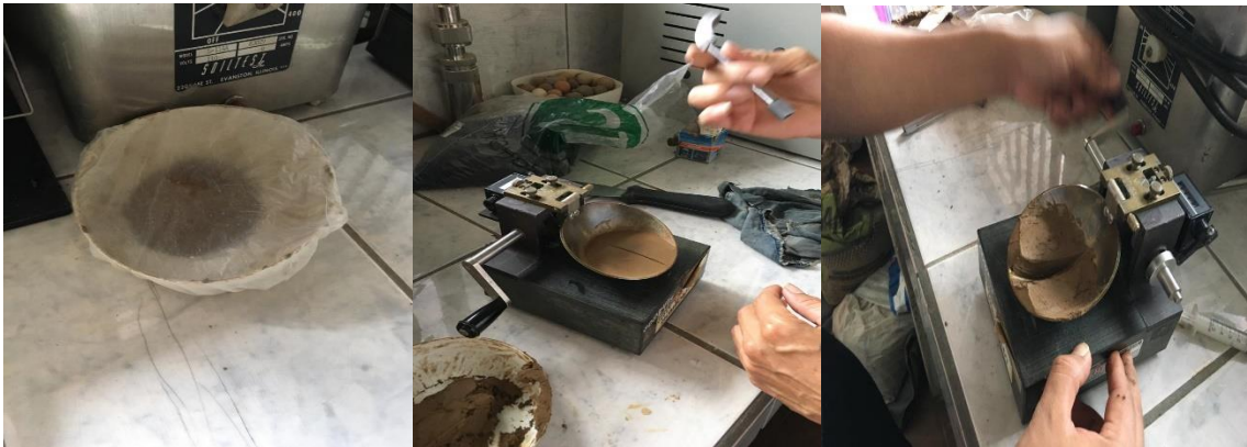
Ilustración 8-3: Cálculo del límite líquido de la arcilla
