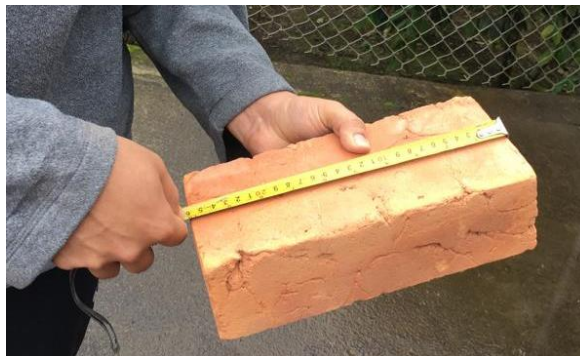
Ilustración 18-3: Medición del ladrillo tipo cocido
