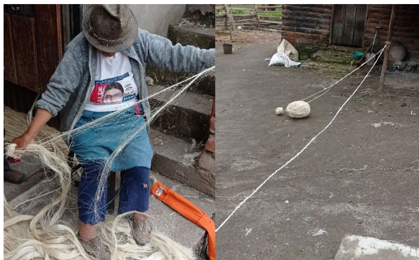
Ilustración 2-1. Proceso rajado y trenzado de la cabuya negra ( Agave americana )
