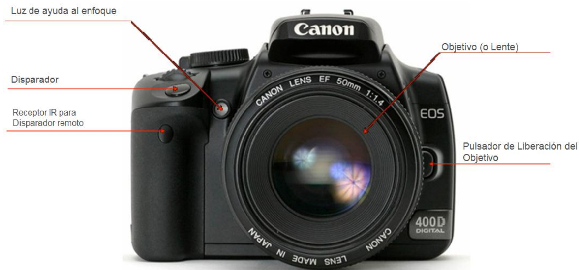
Figura III.7 Estructura básica externa - frontal
