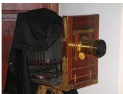
Figura II.16 Cámara de estudio del siglo XIX con fuelle para enfocar
