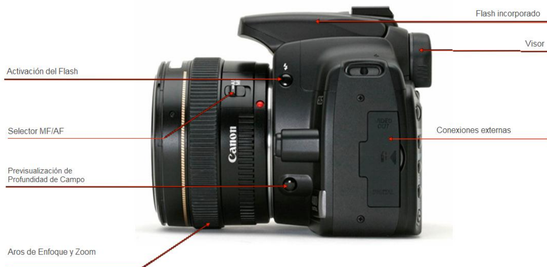
Figura III.8 Estructura básica externa - lateral
