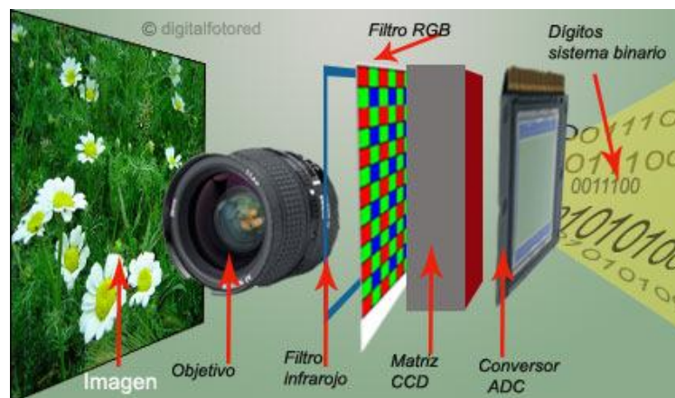
Figura III.24 Formación de la imagen digital
