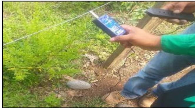
**Ilustración 4-35:** Práctica de comprobación de fuga de energía con el voltímetro
