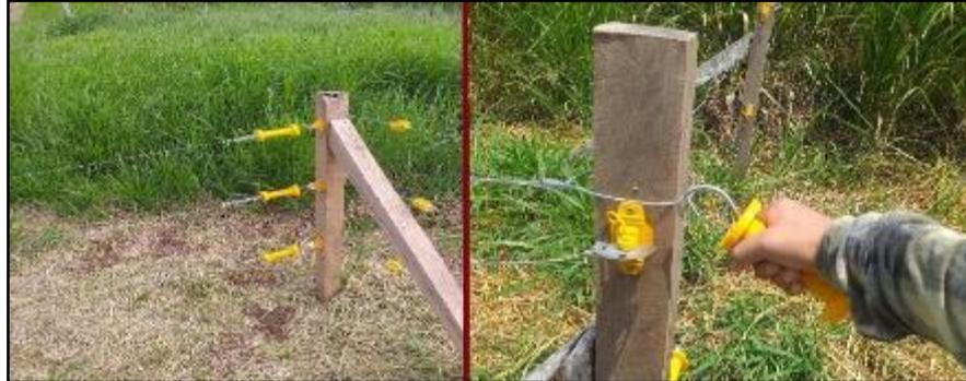
**Ilustración 4-28:** Demostración de instalación del kit de puertas con maniguetas moderno
