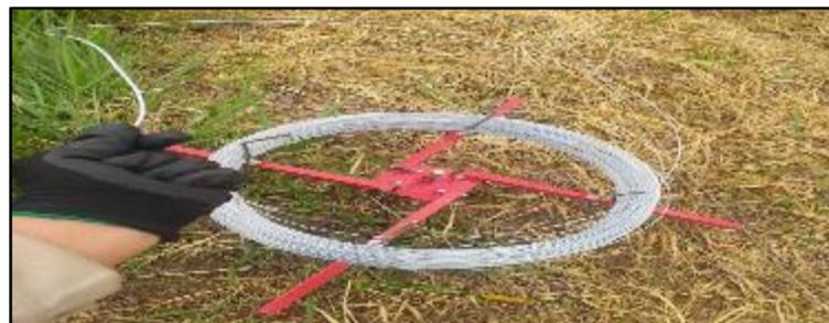
**Ilustración 4-18:** Alternativa demostrativa del dispensador de alambre rotatorio
