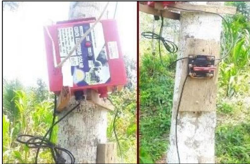
**Ilustración 4-21:** Demostración de instalación del energizador múltiple y la palanca doble tiro
