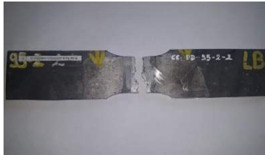
Ilustración 10-4: Probeta ensayada a tracción
