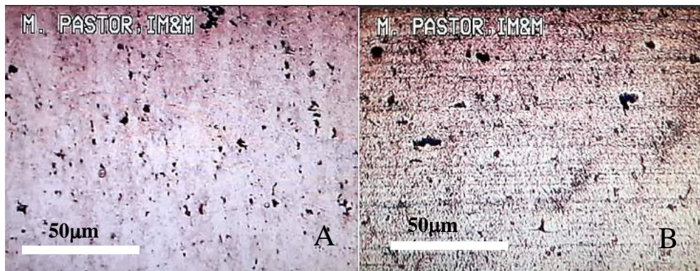
Ilustración 2-4: Plancha 7075 T6 (A) vista superior, (B) vista lateral a 500X
