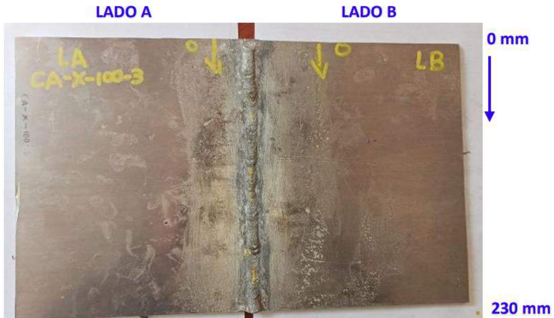
Ilustración 6-4: Esquema de una placa para ultrasonido
