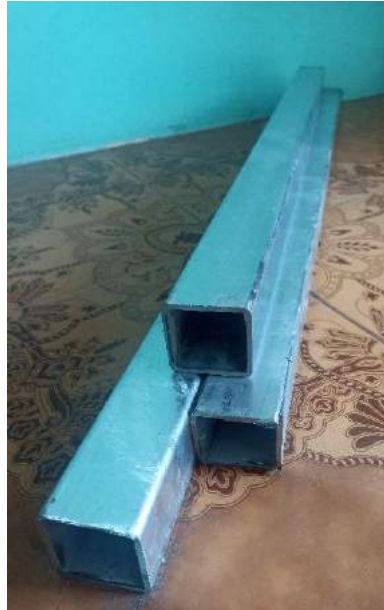
Ilustración 3-1: Tubo cuadrado acero ASTM A-500 galvanizado Realizado por: Gallegos. N & Guayaulema. J, 2023
