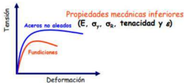
Ilustración 2-14: Propiedades mecánicas deformación- tensión. Fuente: (Askeland. D, 2010)
