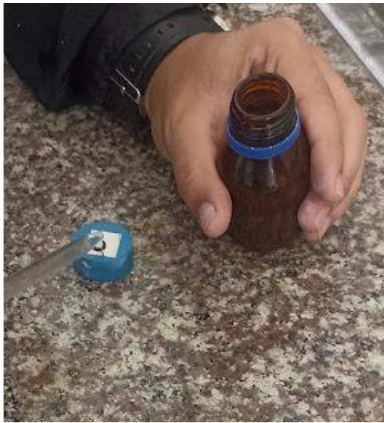
Ilustración 3-18: Ataque Químico acero ASTM A-500 galvanizado
