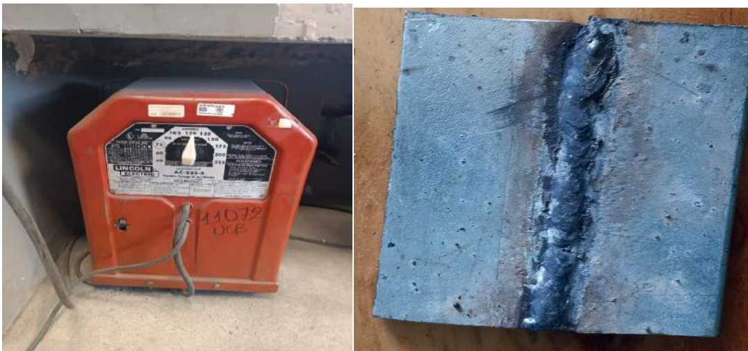
Ilustración 3-14: Soldadura SMAW de placa de acero ASTM A-500 galvanizado
