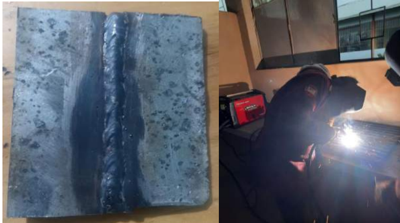
Ilustración 3-20: Soldadura GMAW de placa de acero ASTM A-500 Realizado por: Gallegos. N & Guayaulema. J, 2023
