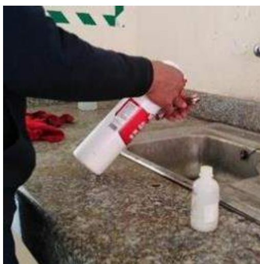
Ilustración 3-10: Limpieza de la baquelita luego del ataque químico Realizado por: Gallegos. N & Guayaulema. J, 2023
