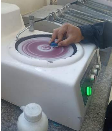
Ilustración 3-24: Pulido cordón de soldadura GMAW de acero ASTM A-500.
