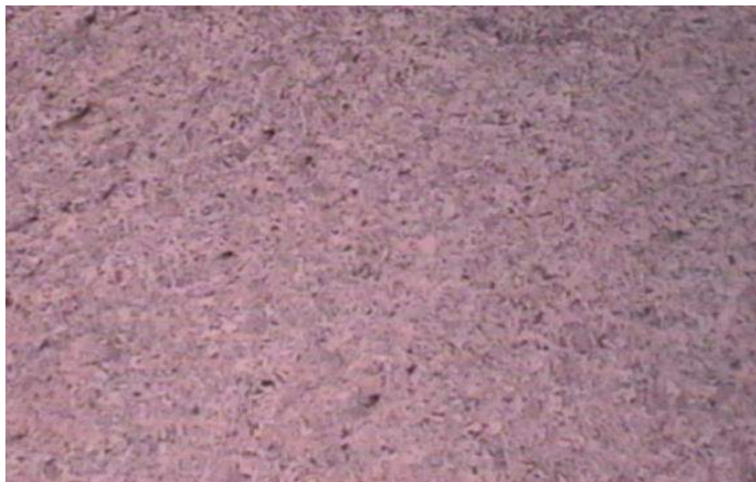
Ilustración 3-13: Microestructura del acero galvanizado original 5x Realizado por: Gallegos. N & Guayaulema. J, 2023.
