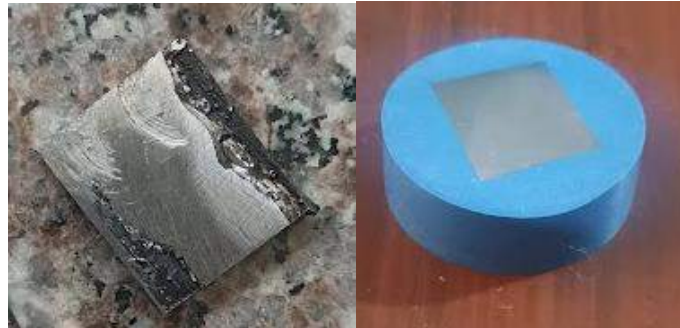
Ilustración 3-22: Baquelita cordón de soldadura GMAW acero ASTM A-500 Realizado por: Gallegos. N & Guayaulema. J, 2023.
