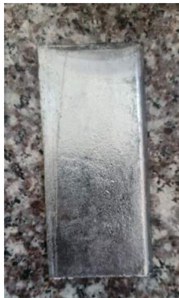
Ilustración 3-2: Placa de 50x100 mm de acero ASTM A-500 galvanizado Realizado por: Gallegos. N & Guayaulema. J, 2023
