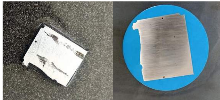
Ilustración 3-16: Baquelita cordón de soldadura SMAW acero ASTM A-500 galvanizado Realizado por: Gallegos. N & Guayaulema. J, 2023
