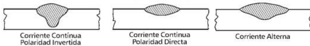
Ilustración 2-10: Efecto de la polaridad y del tipo de corriente.
