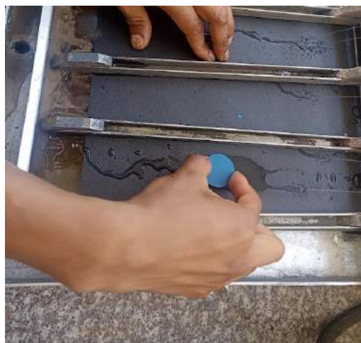
Ilustración 3-23: Desbaste cordón de soldadura GMAW acero ASTM A-500 Realizado por: Gallegos. N & Guayaulema. J, 2023.
