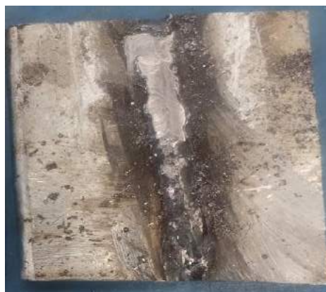
Ilustración 3-21: Fresado de placa de acero ASTM A-500 Realizado por: Gallegos. N & Guayaulema. J, 2023.
