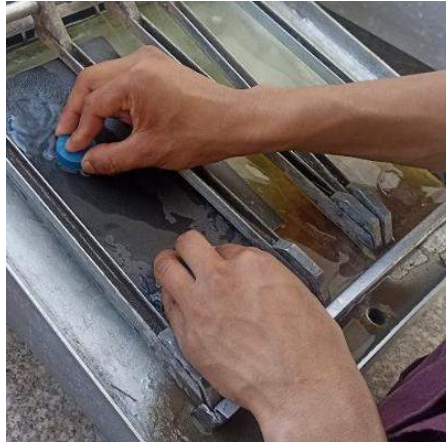
Ilustración 3-17: Desbaste cordón de soldadura SMAW acero ASTM A-500
