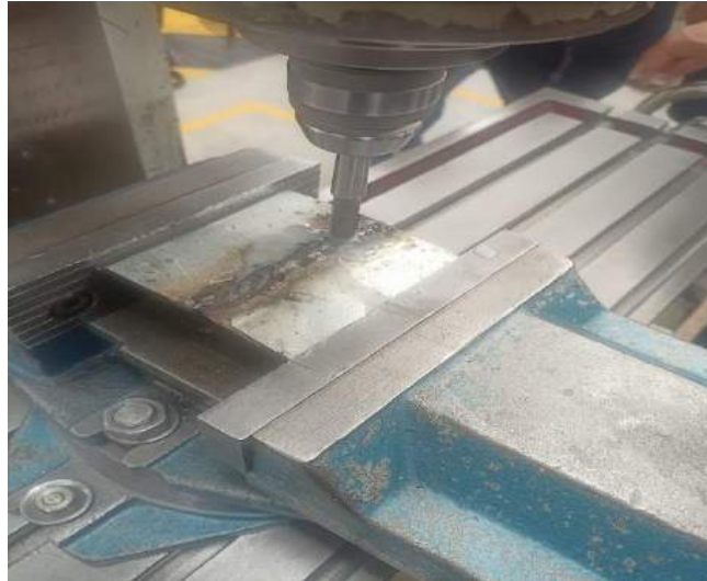
Ilustración 3-15: Fresado de placa de acero ASTM A-500 galvanizado Realizado por: Gallegos. N & Guayaulema. J, 2023.
