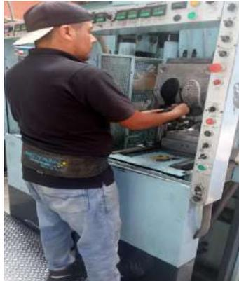
**Ilustración 3-10:** Inyector retirando las suelas
