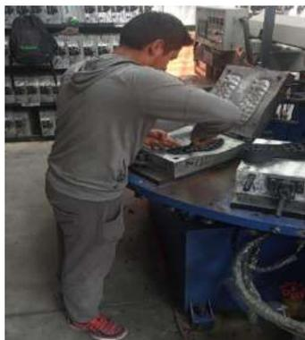
**Ilustración 3-9:** Inyector sacando las suelas
