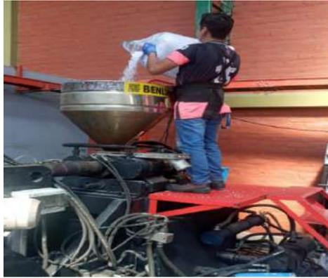
**Ilustración 3-12:** Abastecimiento de inyectoras
