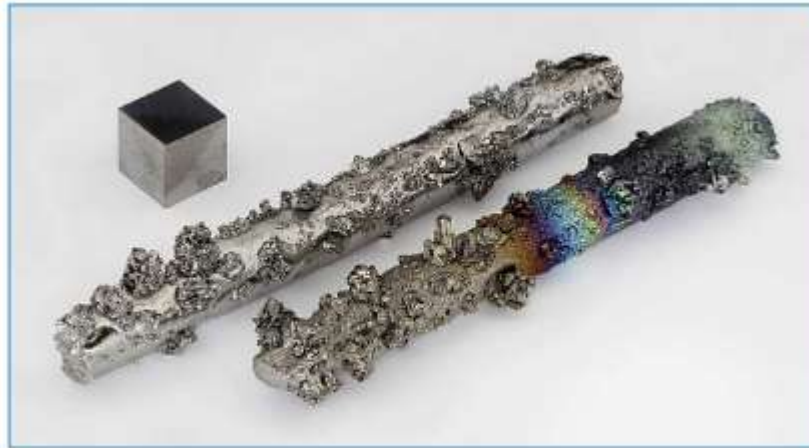
Figura 7-1. Varillas de wolframio con cristales evaporados parcialmente oxidada y un cubo con pureza de 99,999 %
