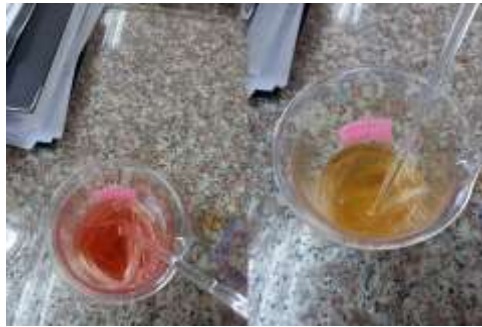
Gráfico 3.5: Reacción de la disolución con la fibra de cabuya, se puede ver el cambio de color de la disolución con el tiempo.
