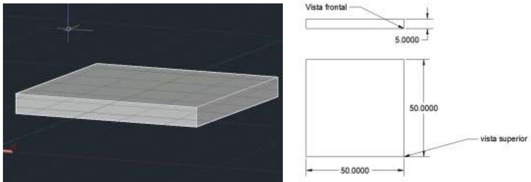
Gráfico 3.13: Placa de aluminio de 5cm de espesor, peso 60.75kg.
