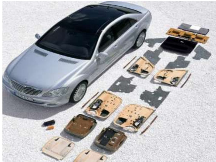
Gráfico 2.11 : Modelo automóvil con componentes a base de fibras naturales.
