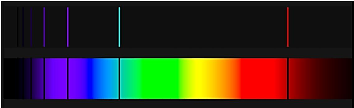
**Ilustración 4-2.** Líneas de emisión (superior) y absorción (inferior) del hidrógeno.
