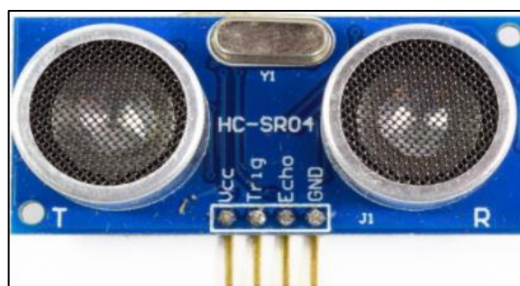
Figura 10 - 2. Sensor ultrasónico HC-SR04
