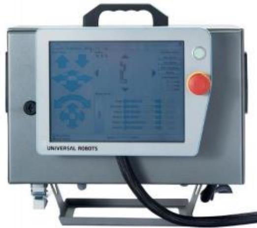
**Figura 7-1.** Caja de control y consola de programación del brazo robot UR3
