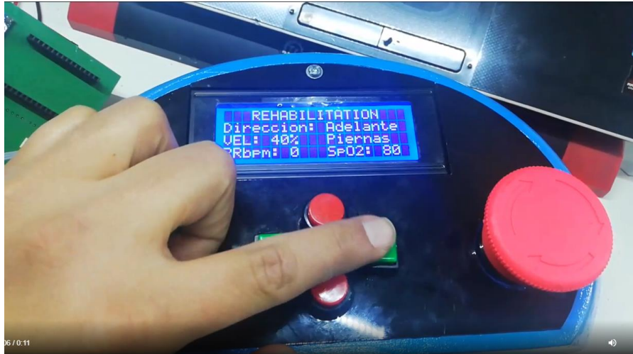
Figura 17-3: Tablero de control del prototipo de rehabilitación.
