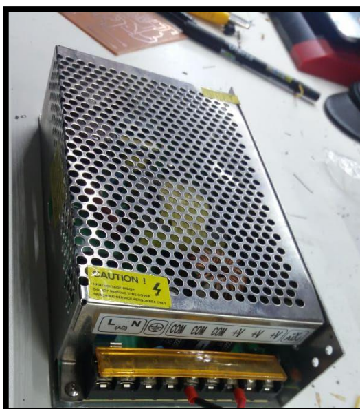
Figura 12-3: Fuente de 12V a 20 A
