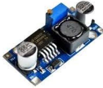
**Figura 3-2.** Regulador de voltaje LM2596.
