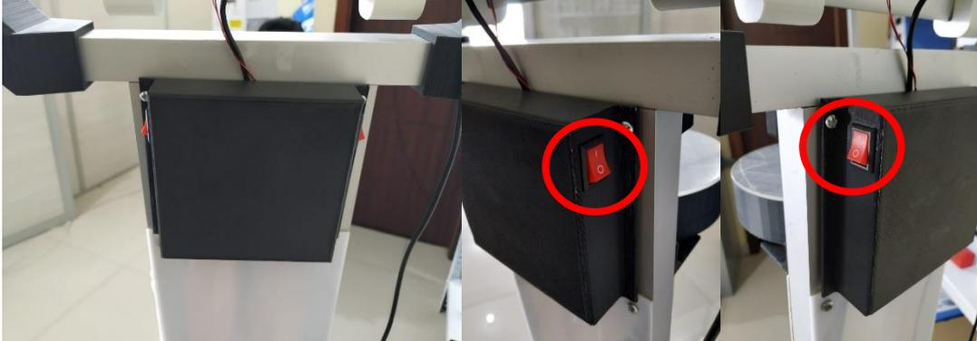
Para asegurar el correcto funcionamiento del robot, los indicadores de voltaje de cada batería deben marcar un valor mayor a 12,5v. Para apagar al robot se deben accionar los interruptores para pasar de la posición I a la posición 0.
