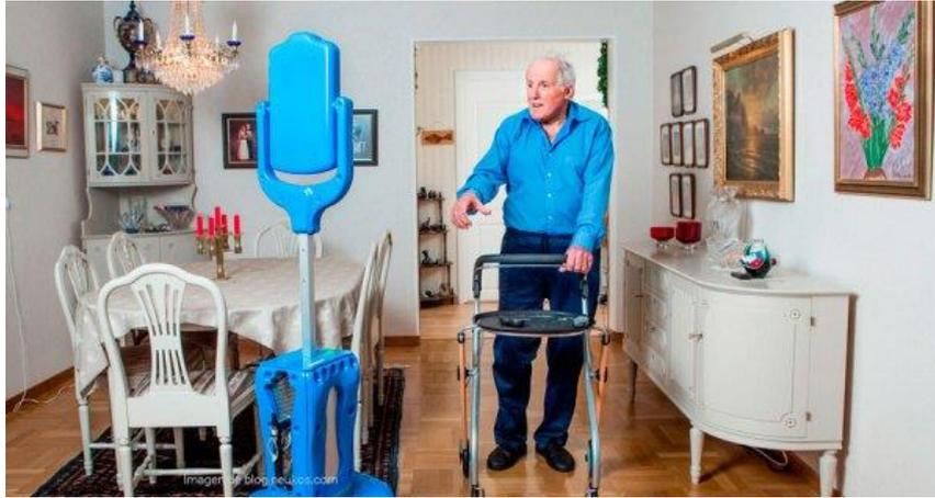
**Figura 3-1.** Robot para teleasistencia Giraff.
