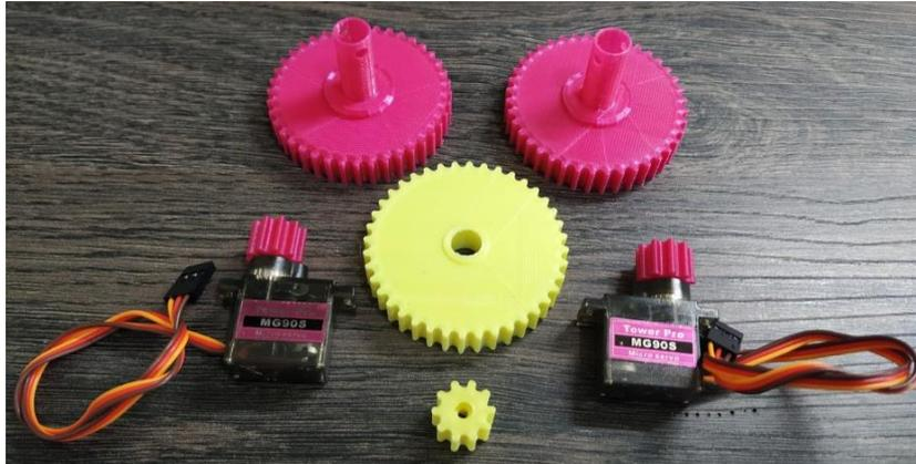
**Figura 27-2.** Engranajes impresos en 3D para movimiento de cabeza.
