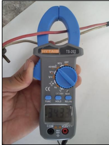
Figura 56-3. Medición de corriente Realizado por: Remache Sagva, Edison, 2021.
