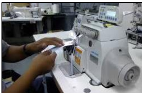
Figura 16-2. Remalladora automática Jk-798E-4 Fuente: https://bit.ly/2tRSS1M .
