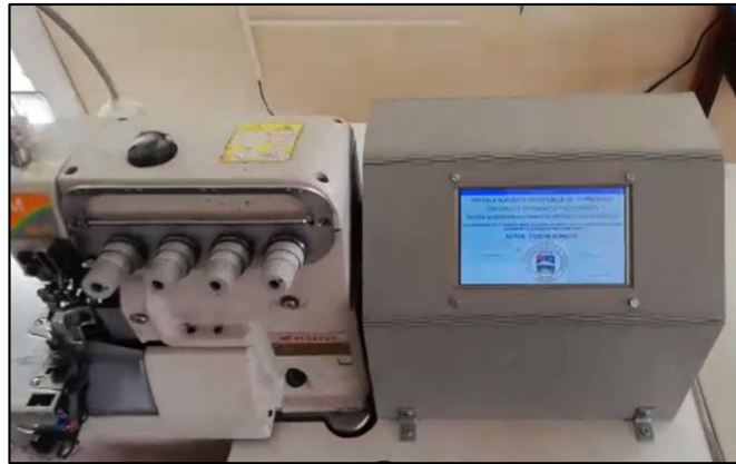
Figura 45-3. Instalación de la cubierta del motor Realizado por: Remache Sagva, Edison, 2021.
