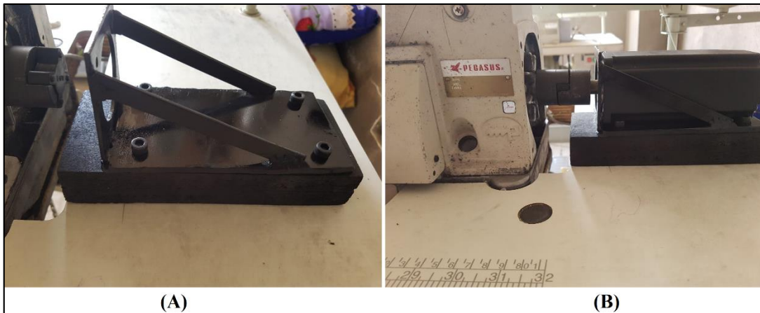
Figura 43-3. Instalación; (A) Base del motor, (B) Acople motor-máquina
