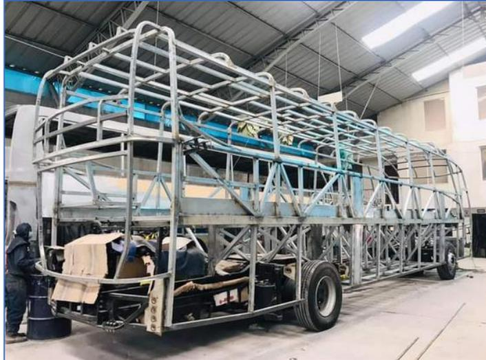
**Ilustración 15-1:** Estructura de bus
