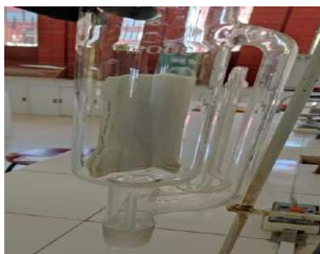
Dedal de muestra colocada para la extracción de aceite
