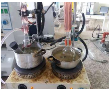
Calentamiento de la muestra para determinar los grupos OH mediante el índice de acetilo
