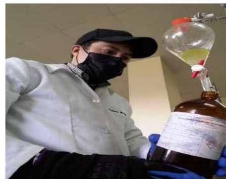
Lavado del aceite esencial acetilado con agua destilada
