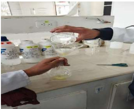
Filtración del aceite esencial acetilado
