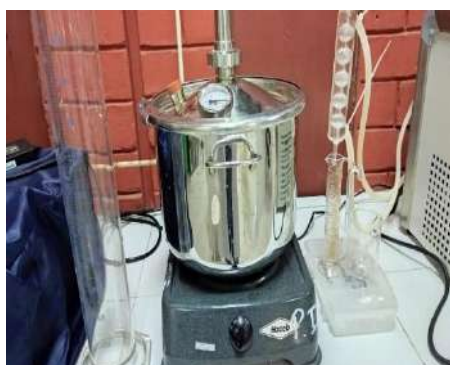
Olla de destilación de vapor para extracción de aceite esencial
