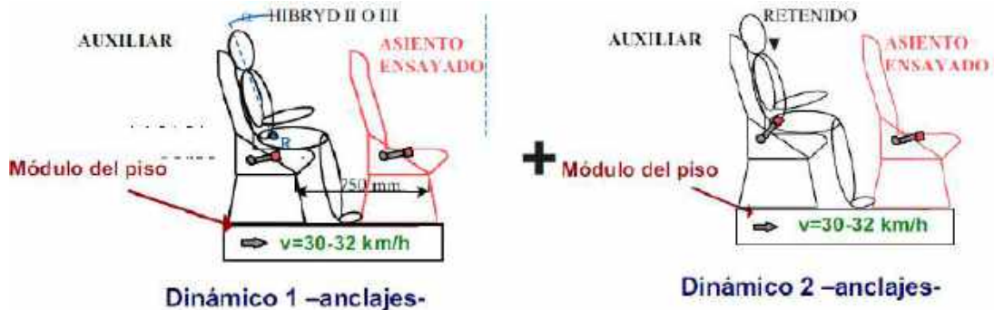
Figura 12-2. Esquema de ensayos dinámicos de resistencia de anclajes de asientos
