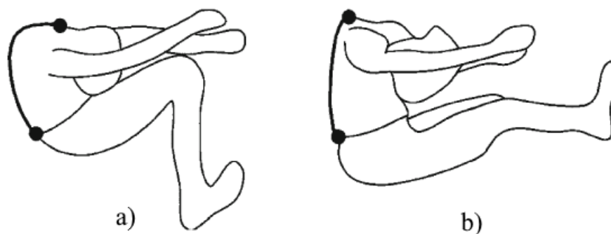
Figura 74-4. a) Cadáver niño en sistema de cinturón de 3 puntos, b) híbrido III 6 años en sistema de cinturón de 3 puntos
