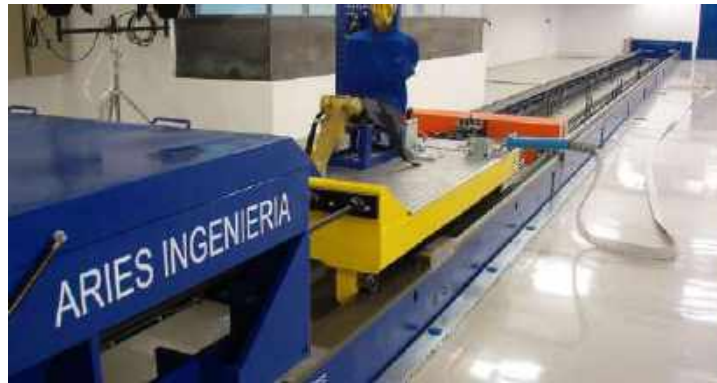
Figura 30-2. Trineo de impacto modelo Aries
