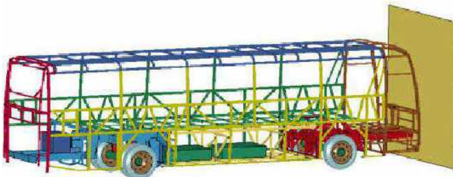
Figura 11-2. Modelo de prueba de impacto frontal según la prueba EURO NCAP
