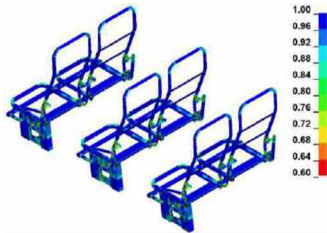
Figura 12-3. Calidad de malla estructura del asiento según criterio Jacobiano.
