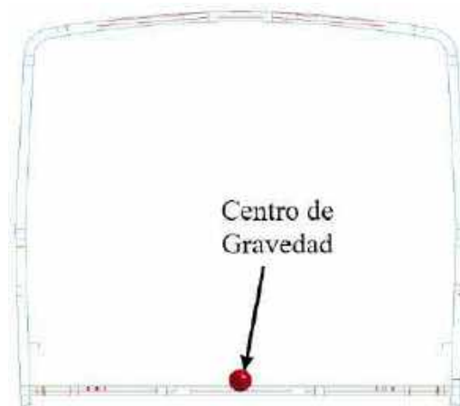
Figura 32-4. Centro de gravedad de la sección carrocería
