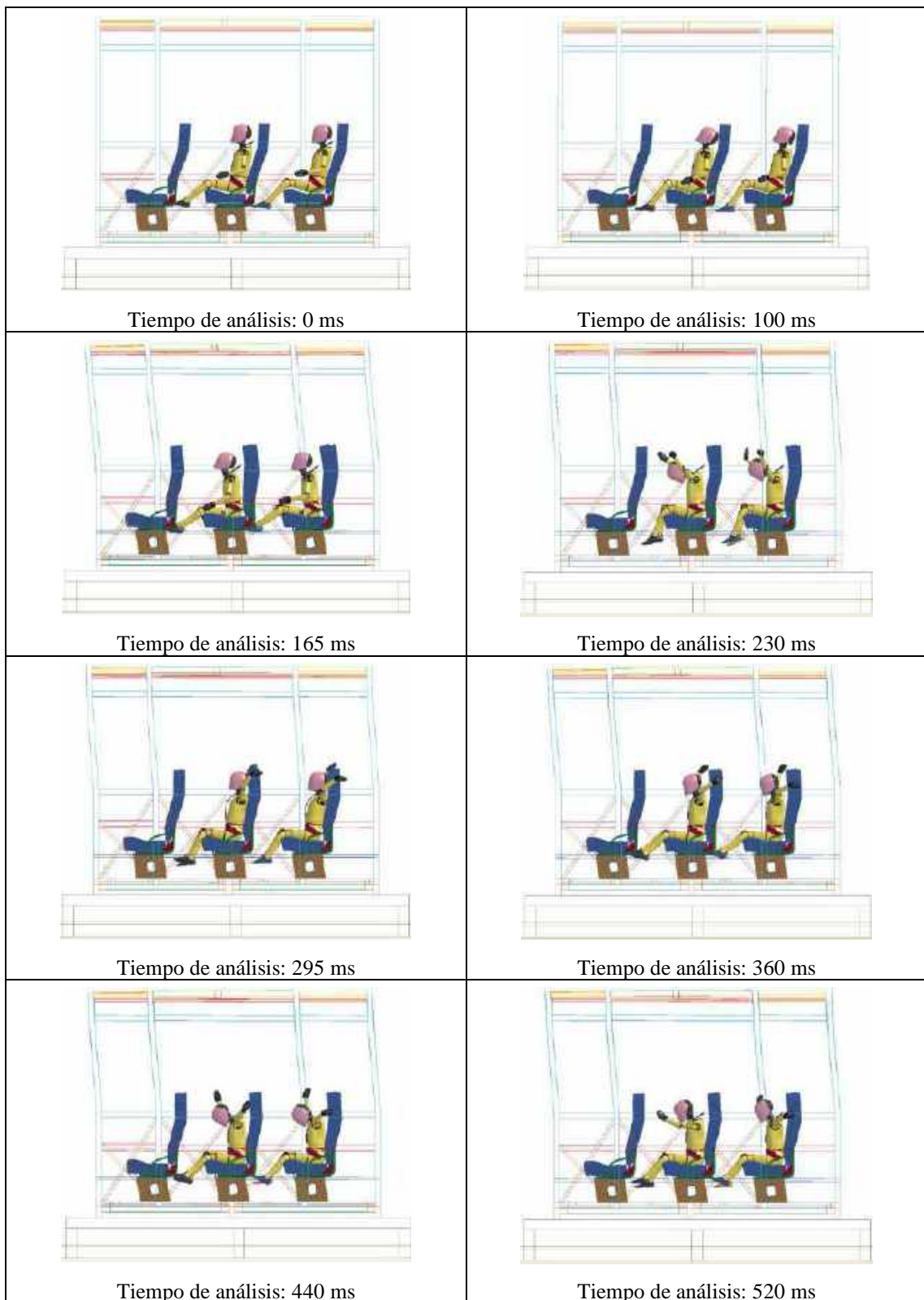
Figura 54-4. Secuencia de impacto frontal cuando el maniqué con cinturón de seguridad
