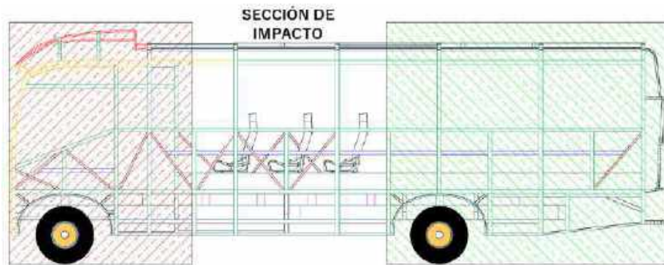
Figura 30-4 División de secciones de la carrocería
