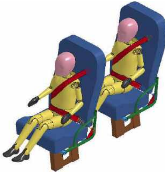
Figura 43-4. Instalación de los cinturones de seguridad en los maniqués
