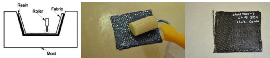
Figura 6-2: Proceso de estratificación manual
