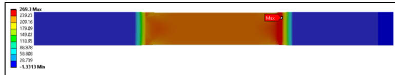
Figura 19-3: Esfuerzo normal de laminado con configuración a 0/90/45
