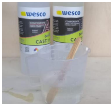
Figura 6-3: Preparación de la resina epóxica
