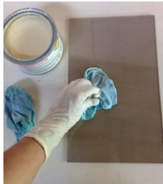
Figura 5-3: Aplicación de agente desmoldante
