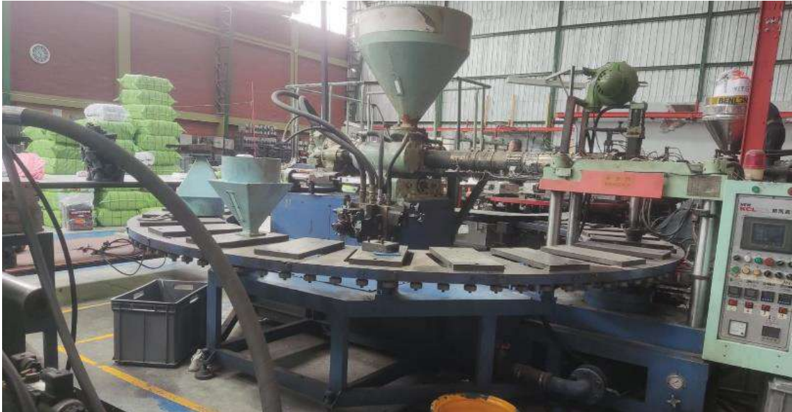
Ilustración 3-6: Máquina automática rotativa de moldeo por inyección de PVC
