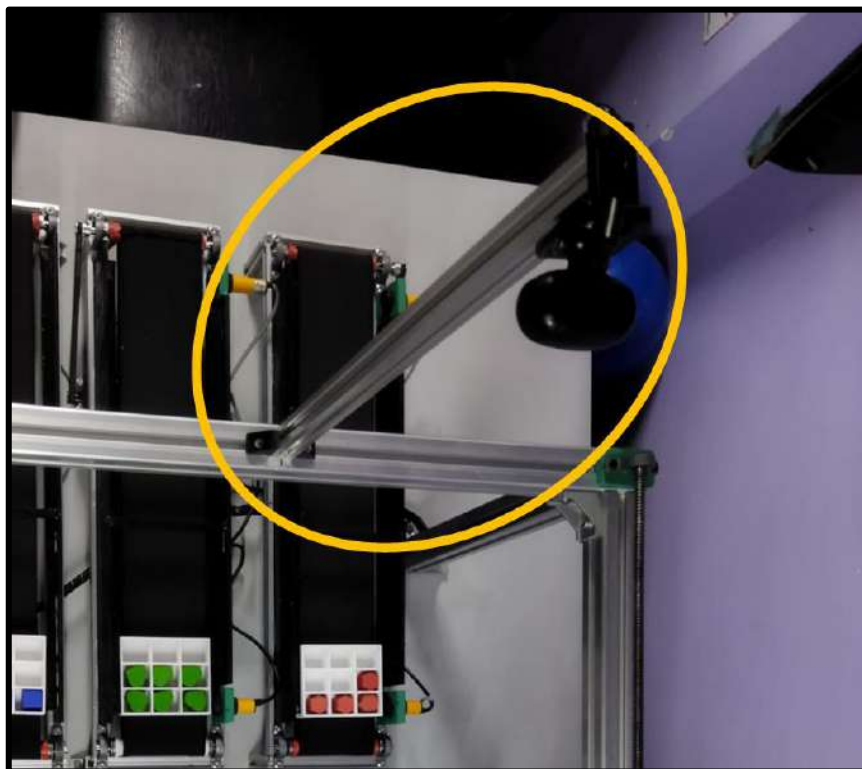
Ilustración 3-42: Soporte de cámara web para la sección identificación.
