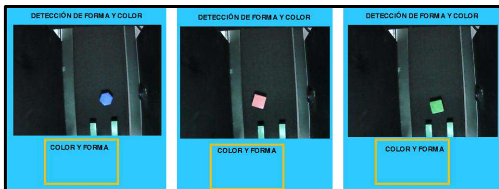
Ilustración 4-13: Resultados de detección de color y forma (piezas a desechar)
