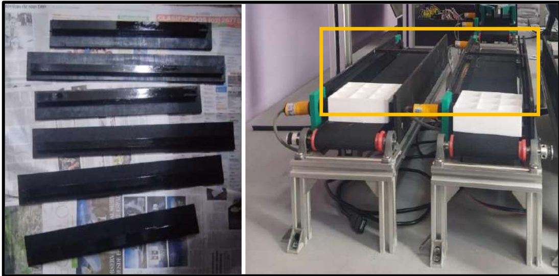
Ilustración 3-43: Guías de madera para las bandas de organización
