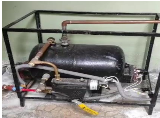
Ilustración 4-12: configuración de la bomba de vapor. Realizado por: Guzmán J; Núñez J. 2023.
