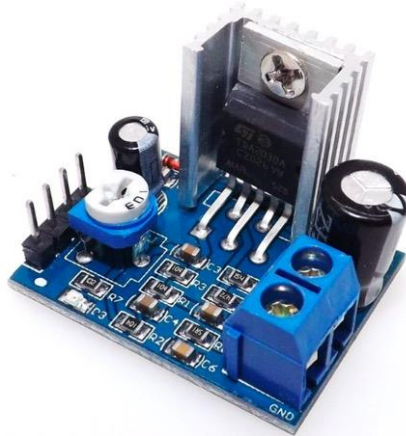
Ilustración 3-10: Módulo amplificador de audio mono TDA2030A
