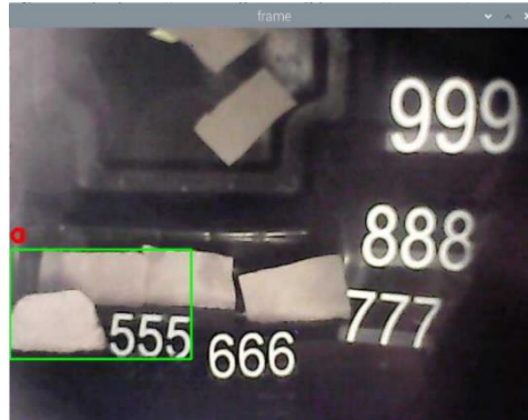
Ilustración 3-14: Detección del nivel de llenado del basurero cuando está al 50%
