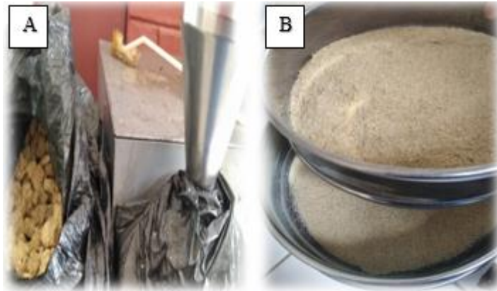
Ilustración 11-3: A) Molienda de tusa y B) Tamizado
