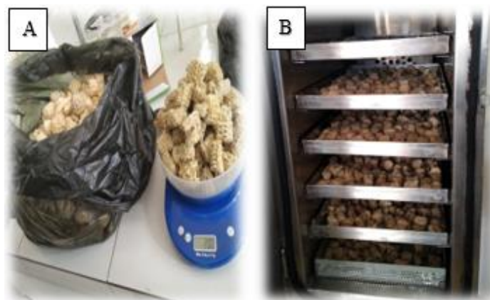
Ilustración 10-3: A) Troceado de la tusa y B) Secado en estufa
