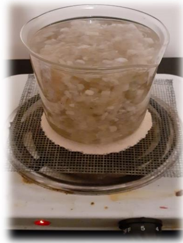
Ilustración 18-3: Eliminación del carbón Realizado por: Estrada, Paola, 2022.
