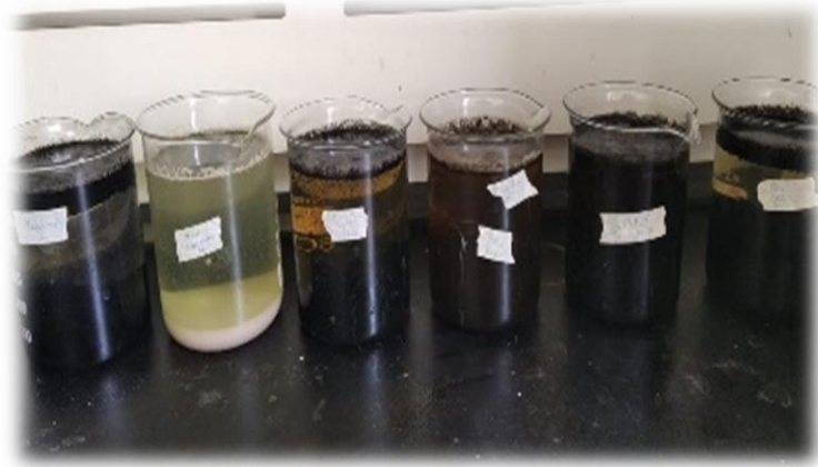
Ilustración 20-3: Tratamiento alcalino de celulosa
