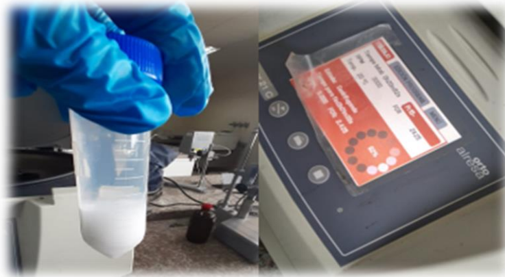
Ilustración 24-3: Centrifugado y lavado de nanocelulosa
