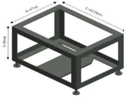
**Ilustración 26-4:** Dimensiones de la estructura
