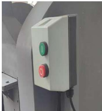
**Ilustración 20-4:** Esquema del panel de control
