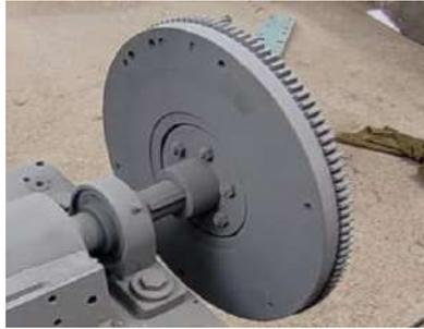
**Ilustración 12-4:** Esquema del volante de inercia
