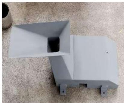
**Ilustración 14-4:** Esquema de la tolva de alimentación
