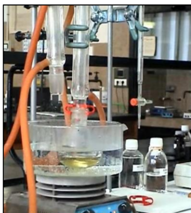
Figura 1-3. Esquema de reflujo en la determinación del índice de saponificación.
