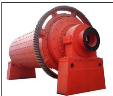
Ilustración 1-2: Molino de Bolas.
