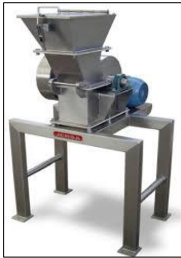
Ilustración 2-2: Molino de martillos.
