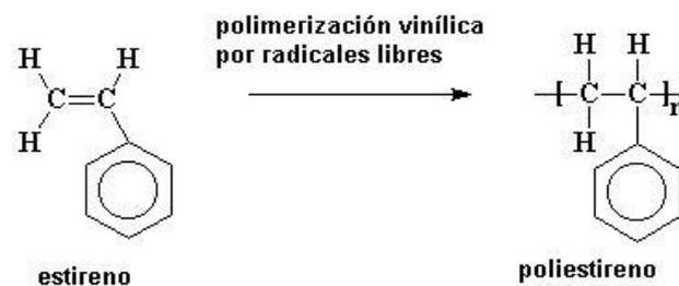
**Figura 1-1:** Obtención del poliestireno por polimerización vinílica
