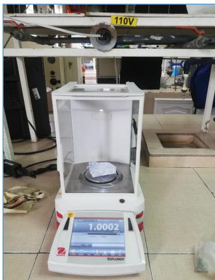
**Figura 2-3:** Peso la muestra pulverizada para el TGA
