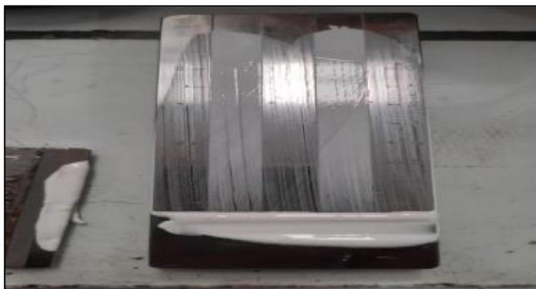
**Figura 2-4.** Grindómetro
