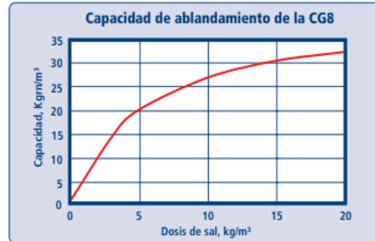
Los datos de capacidad y fuga se basan en lo siguiente: proporción de 2 partes de Ca por 1 parte de Mg, TSD de 500 ppm como CaCO<sub>3</sub>, dureza del 0.2 % en la sal, y concentración de salmuera del 10 % aplicada a corriente a través de la resina durante 30 minutos. No se implementó ninguna disminución técnica.
