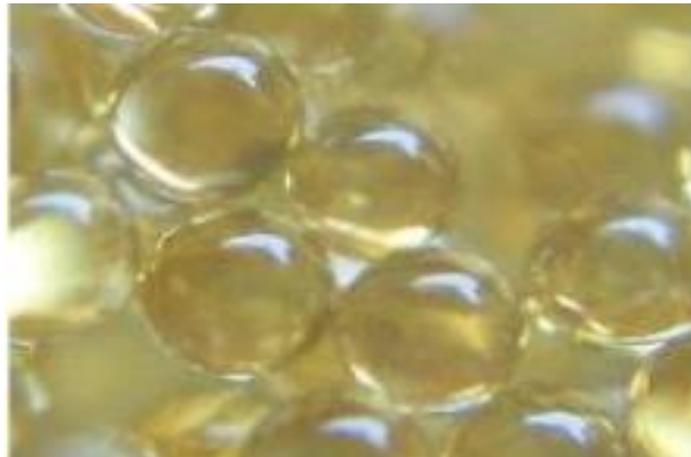
**Ilustración 11-2:** Esferas de resina para el ablandamiento químico.
