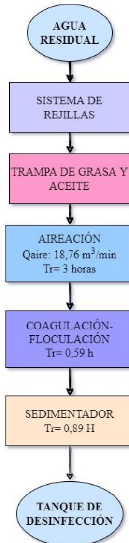
Figura 1-4: Diagrama del sistema de tratamiento de aguas residuales
