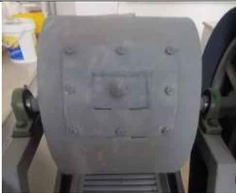
**Coraza o Tambor.** – también llamado casco es la parte externa muy resistente, tiene una forma cilíndrica y en su interior se encuentra las bolas y el material que se quiere moler, diseñado para soportar impactos.
