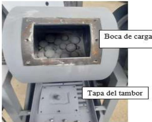
**Boca de carga y descarga.** – Abertura central o lateral por donde ingresa la muestra a moler y sale el material molido.
