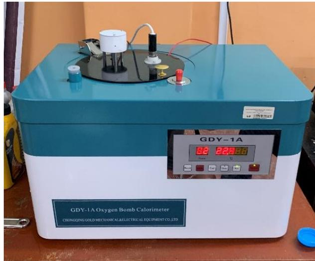
**Ilustración 7-2:** Bomba calorimétrica
