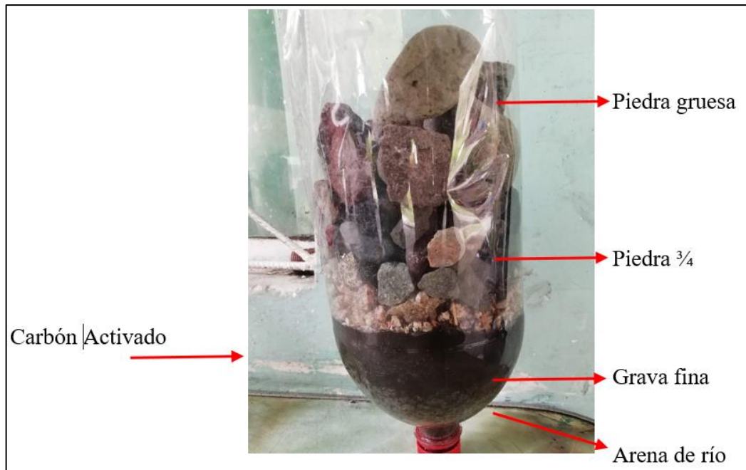
Ilustración 4-3: Sistema de filtro casero
