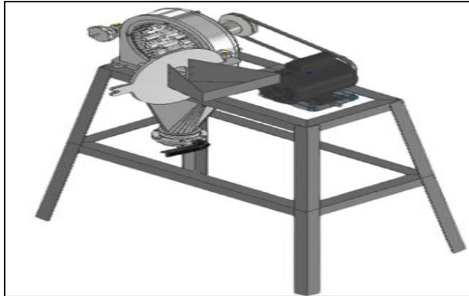
Ilustración 2-4: Diseño conceptual del molino de pines.
