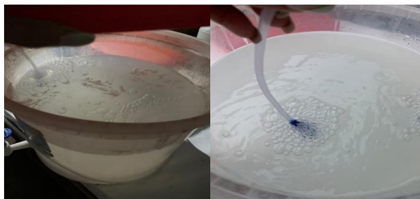
Ilustración 3-4: Aireación y homogenización de las aguas residuales
