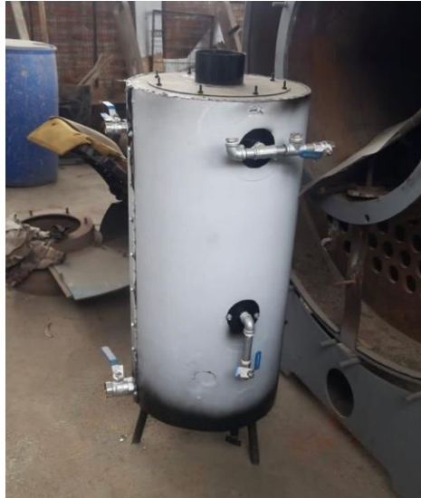
Ilustración 15-3: montaje del calderín
