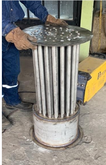
Imagen 6.4 Vista interna del Caldero Simple
