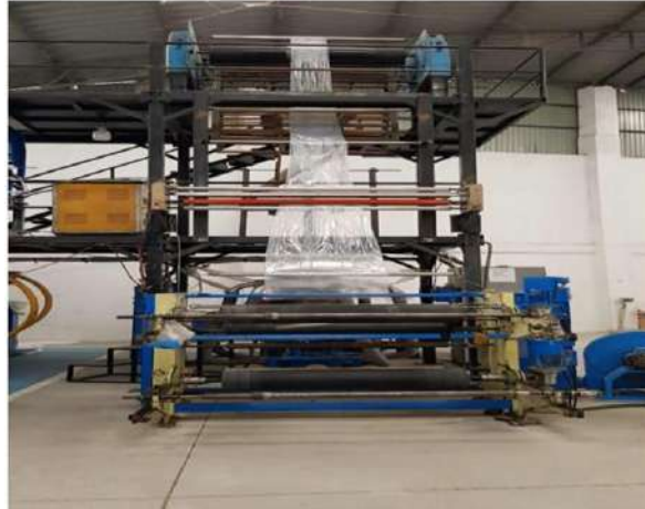
Ilustración 3-8: Envolvimiento de película plástica en un bocín planta M&M Plasticotopaxi.
