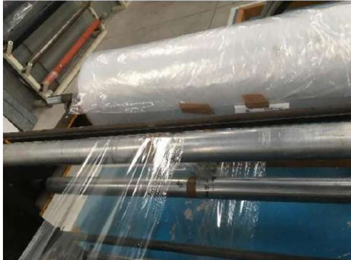
Ilustración 3-9: Envolvimiento de película plástica en un bocín planta M&M Plasticotopaxi
