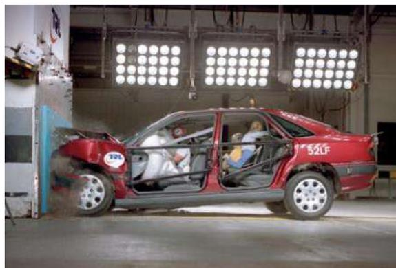
**Ilustración 2-8:** Prueba de colisión frontal con maniqués
