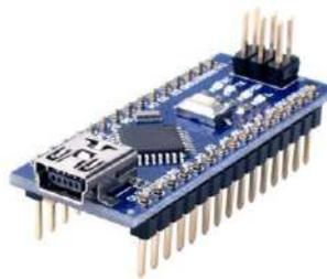
**Ilustración 3-207:** Tarjeta Arduino nano
