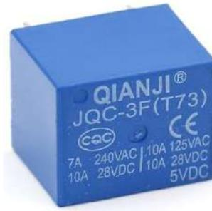
**Ilustración 3-212:** Relay JQC-3 F (T73) 5 VDC
