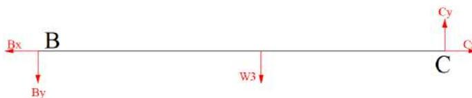
**Ilustración 3-15:** Iteración 1, diagrama de cuerpo libre, biela BC
