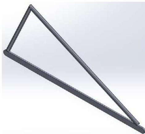
**Ilustración 3-158:** Diseño. Segunda iteración. CAD del acoplador
