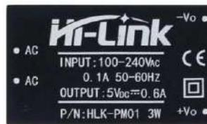
**Ilustración 3-209:** Mini Módulo De Fuente De Alimentación Hi-link 5v
