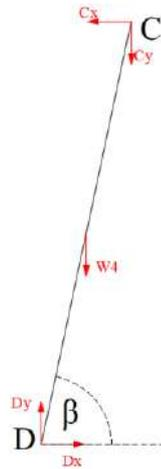
**Ilustración 3-18:** Iteración 1, diagrama de cuerpo libre 2, balancín CD
