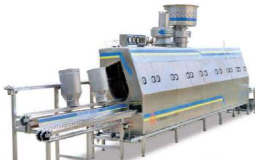
Ilustración 2-2: Máquina de limpieza de contenedores de leche.
