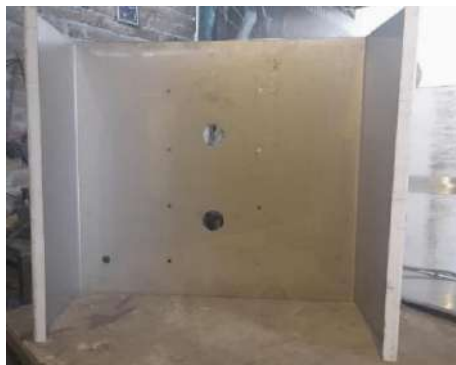
Ilustración 3-47: Doblado de la cubierta del sistema de transmisión.
