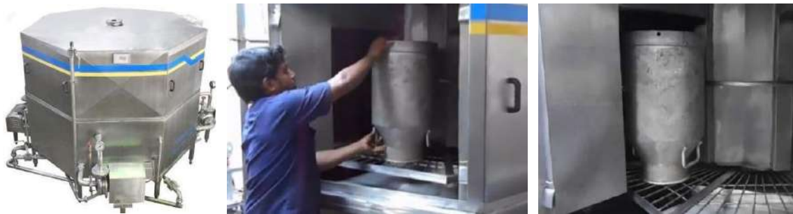
Ilustración 2-3: Lavadora rotativa de bidones de leche.
