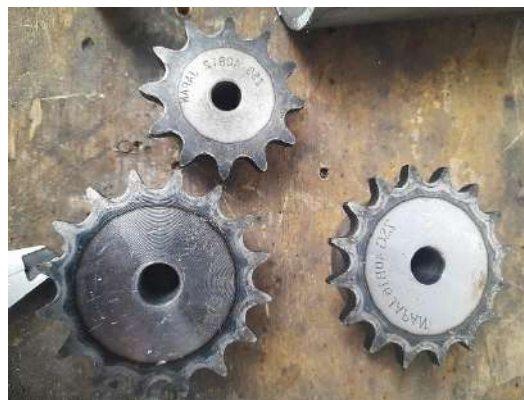
Ilustración 3-10: Conjunto de piñones normalizados adquiridos
