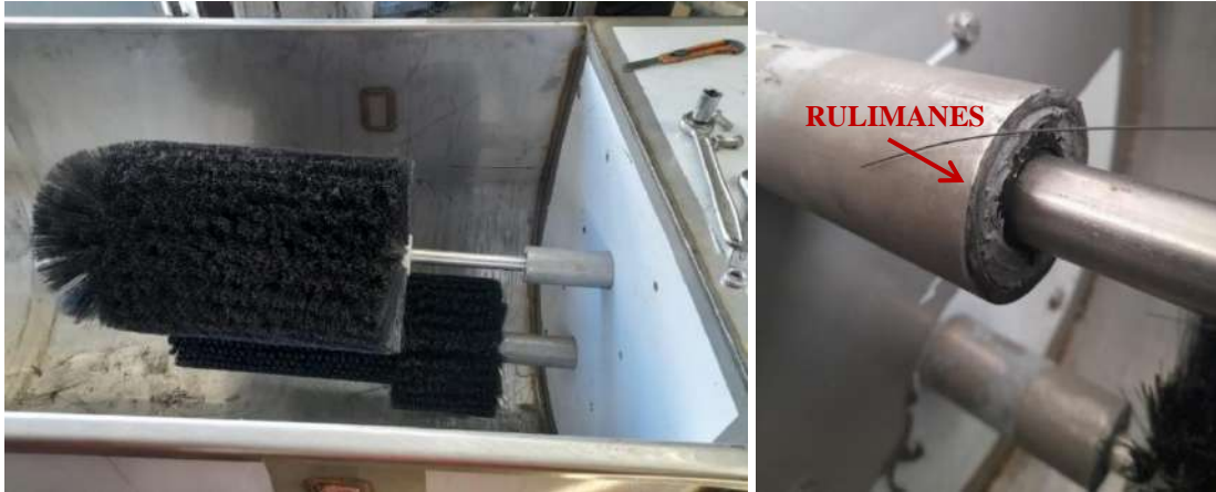
Ilustración 3-49: Montaje de los cepillos de lavado.
