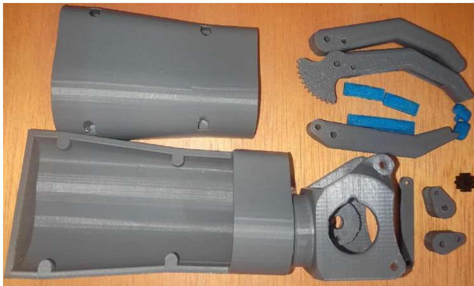
Ilustración 4-16: Componentes impresos de la prótesis
