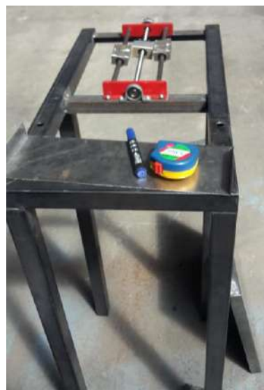
Ilustración 3-81: Ensamble del sistema mecánico para deslizar la mesa de apoyo Realizado Por: Moyon, S. y Suntaxi, J., 2023
