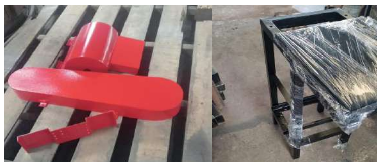
Ilustración 3-83: Proceso de pintado de las partes de la máquina desfibadora Realizado Por: Moyon, S. y Suntaxi, J., 2023
