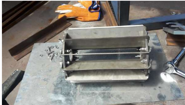
Ilustración 3-80: Construcción del tambor desfibrador Realizado Por: Moyon, S. y Suntaxi, J., 2023
