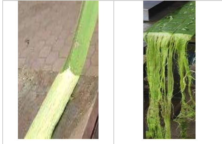
Ilustración 4-18: Fibras obtenidas a partir de la hoja de cabuya blanca Realizado Por: Moyon, S. y Suntaxi, J., 2023
