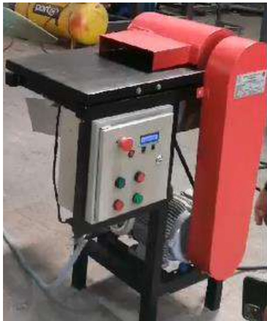
Ilustración 3-85: Ensamble final de la máquina desfibradora Realizado Por: Moyon, S. y Suntaxi, J., 2023
