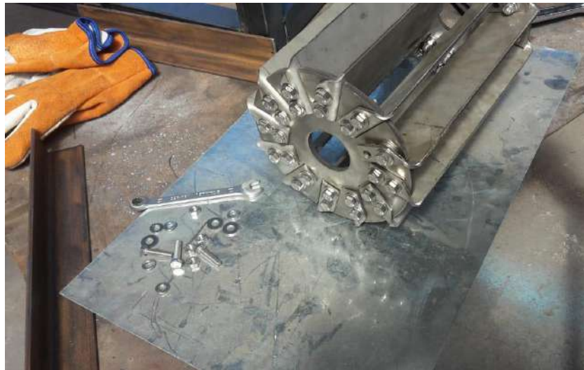
Acople de cuchillas y soportes para ensamblar el tambor desfibrador
