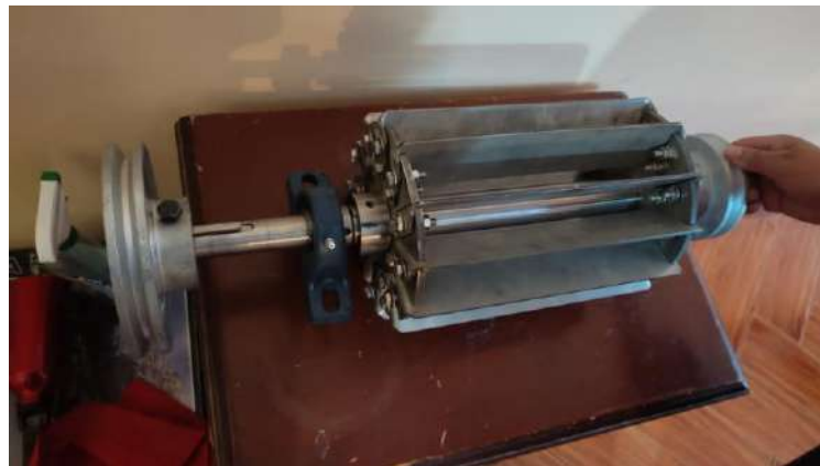
Ilustración 3-82: Construcción y ensamblaje del sistema de desfibrado Realizado Por: Moyon, S. y Suntaxi, J., 2023
