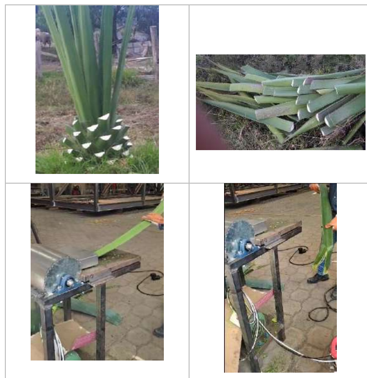
Ilustración 4-16: Proceso para la obtención de fibra de cabuya Realizado Por: Moyon, S. y Suntaxi, J., 2023
