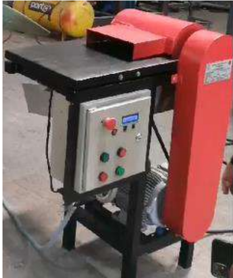
Ensamblaje de los componentes mecánicos de la desfibradora de cabuya
