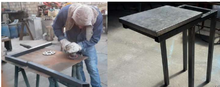
Ilustración 3-79: Construcción de la estructura de la máquina desfibradora Realizado Por: Moyon, S. y Suntaxi, J., 2023
