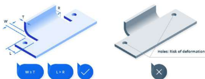
Ilustración 3-18: Desahogos para el plegado de chapa metálica
