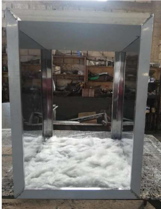
Ilustración 3-33: Colocación de la lana de vidrio.
