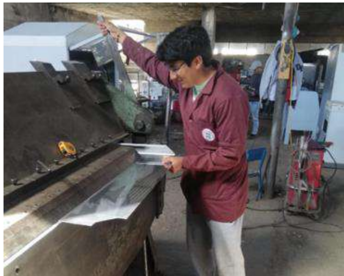
Ilustración 3-31: Proceso de cortado de la chapa metálica.
