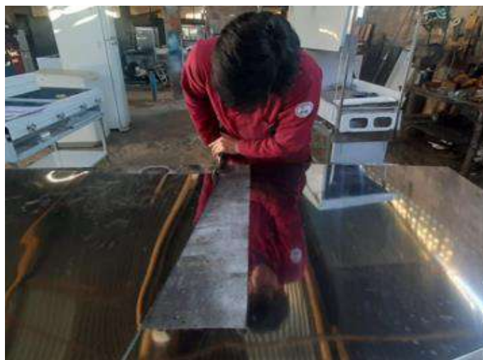
Ilustración 3-30: Proceso de cortado de la chapa metálica.
