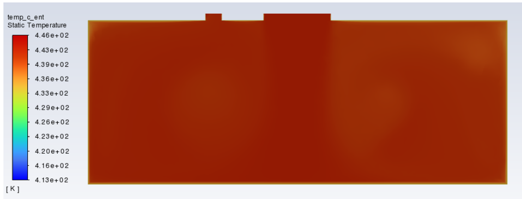
Ilustración 4-12: Distribución de temperatura lateral del modelo de convección y radiación, en la cámara de entrada de aire
