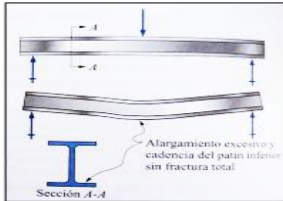
Ilustración 2-11: Cedencia de una parte de la viga
