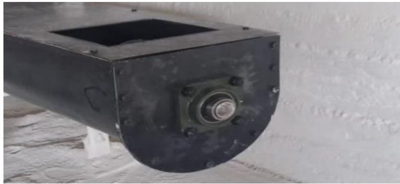
Ilustración 3-41: Instalación de la tapa de los extremos del tornillo
