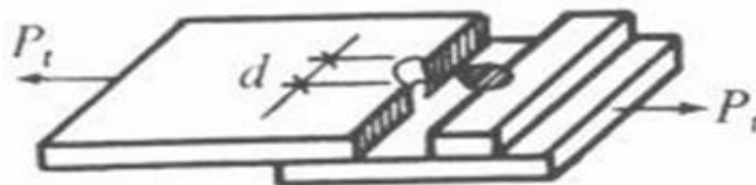
Ilustración 2-19: Fallo debido a rotura de la placa sometida a tracción
