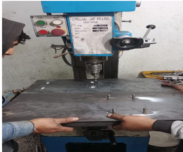
Ilustración 3-35: Construcción de base para el motor
