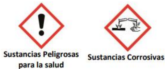
Ilustración 3-63: Peligros debido a la cal
