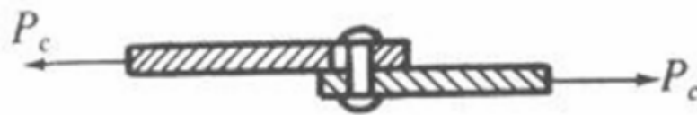
Ilustración 2-18: Fallo por aplastamiento
