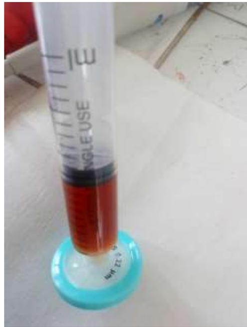
B) Filtrado del extracto alcohólico en poro de 0,22μm
